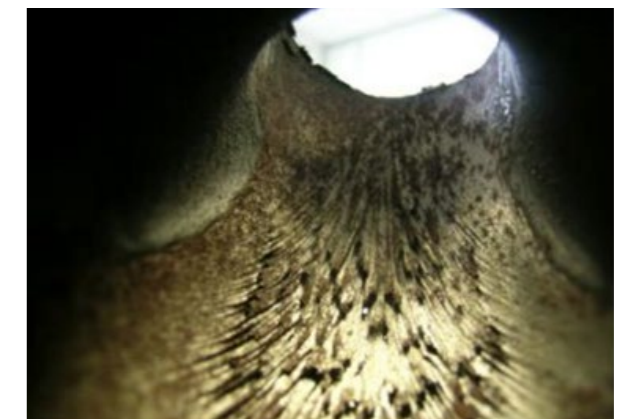
CORROSION PAR ÉROSION SUR CANALISATION EN CUIVRE
