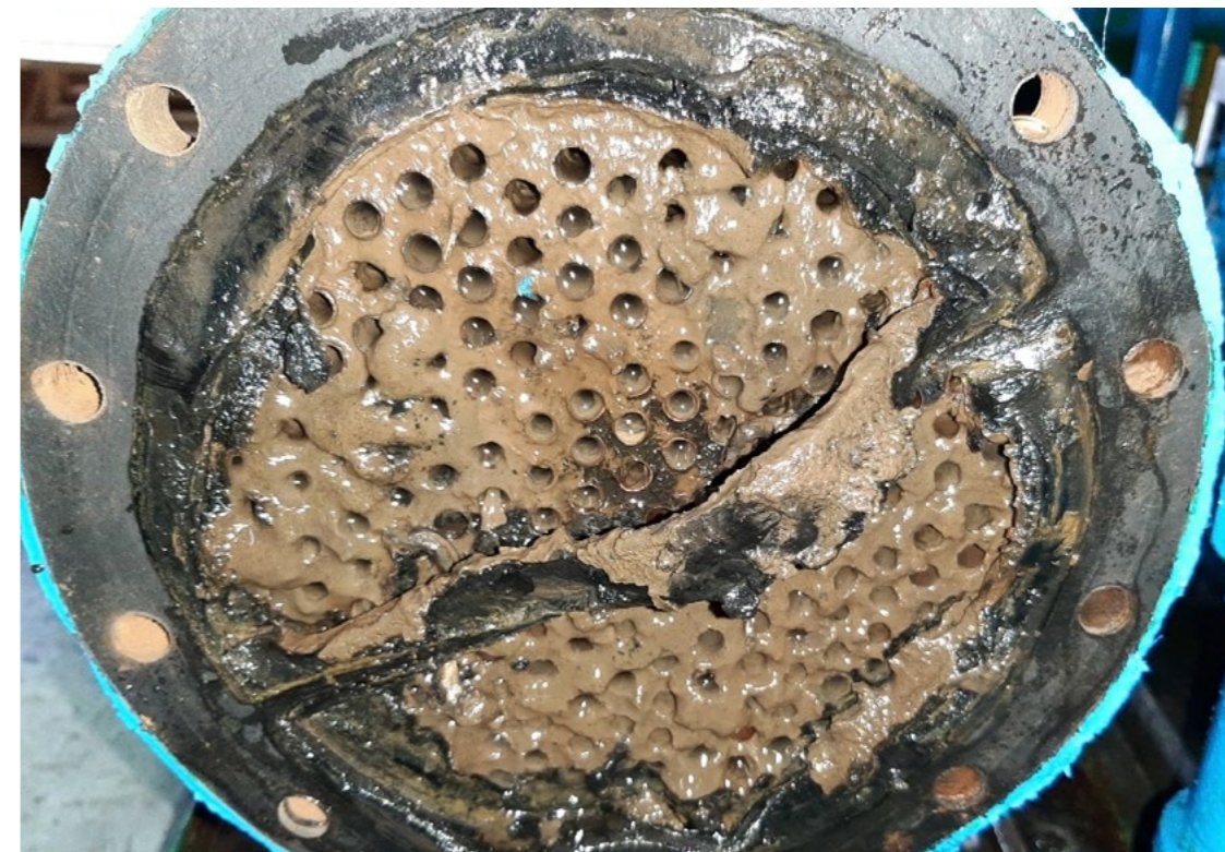
BOUES ORGANIQUES (BIOFILM) SUR UN CONDENSEUR (EN BAS)
