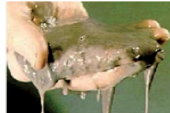
BOUES BIOFILM DÉVELOPPÉES EN PLANCHER CHAUFFANT (EN HAUT)
