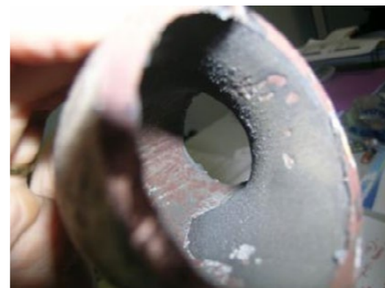
CORROSION PAR ÉROSION SUR CANALISATION EN CUIVRE
